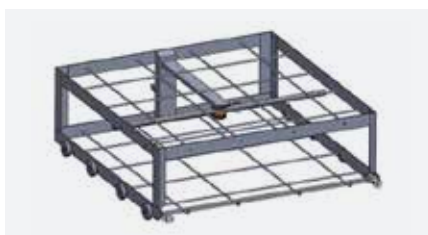
XC-13 Корзина нижняя с коромыслом- распылителем для 4 вставок К-30
