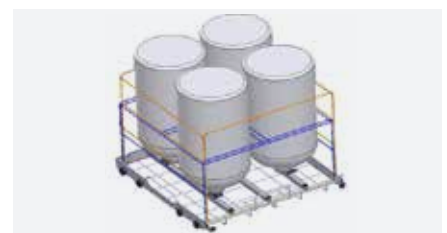
PLYT-04 Модуль инжекторный для 4 бутылей до 10 л, оснащен опорной решеткой
