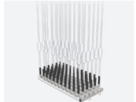
PLWT-66-2 Модуль инжекторный 1/2 для 66 пипеток объемом 10-50 мл
